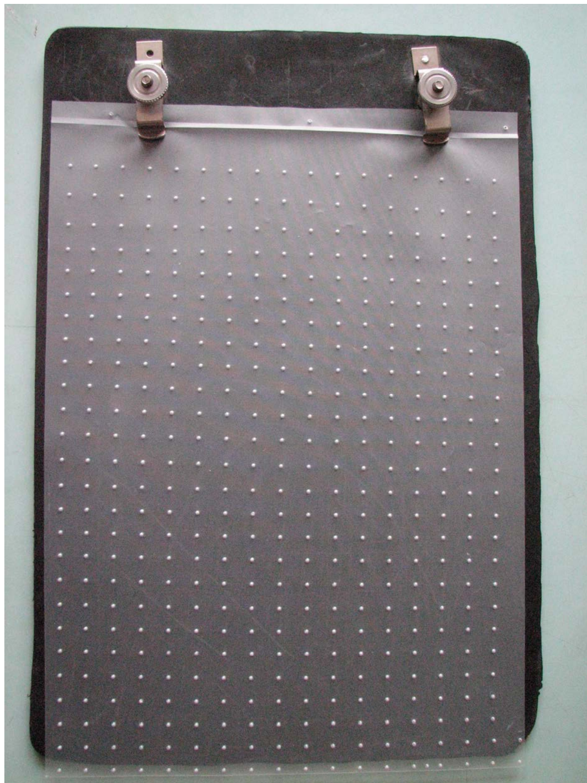
Rys. 61b. Rysownica z folią przygotowana do rysowania wykresów
